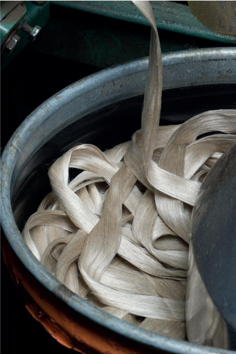
Fase di lavorazione dei filati di lino presso il Linificio e Canapificio Nazionale
